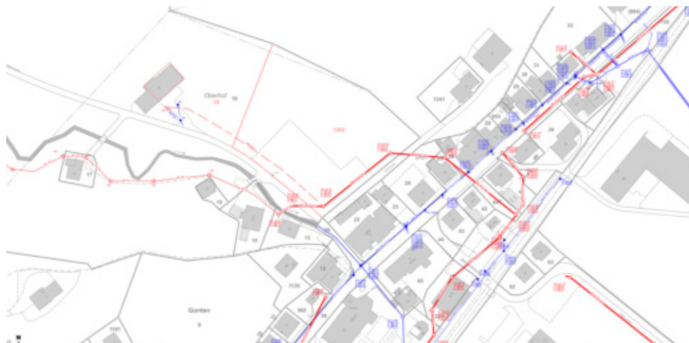
Abb. Ausschnitt Werkleitungsplan Abwasser, geoportal.ch (14.01.2022)
